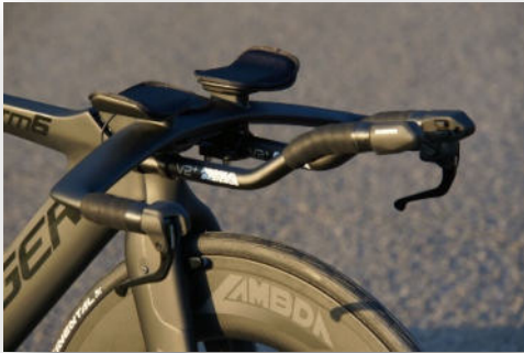
Bild links: Montage der Ausleger unter dem Basislenker. Die hier montierten Ausleger sind von Profile Design Modell V2+ (ca. 50 Euro).
